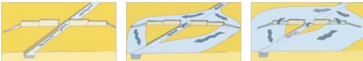
Figure 20 : Fonctionnement des seuils d'épandage. Source : Bender (2011)
